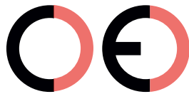
Virheellinen CE-merkki (liian kaukana)
