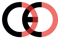
Virheellinen CE-merkki (liian lähellä)
